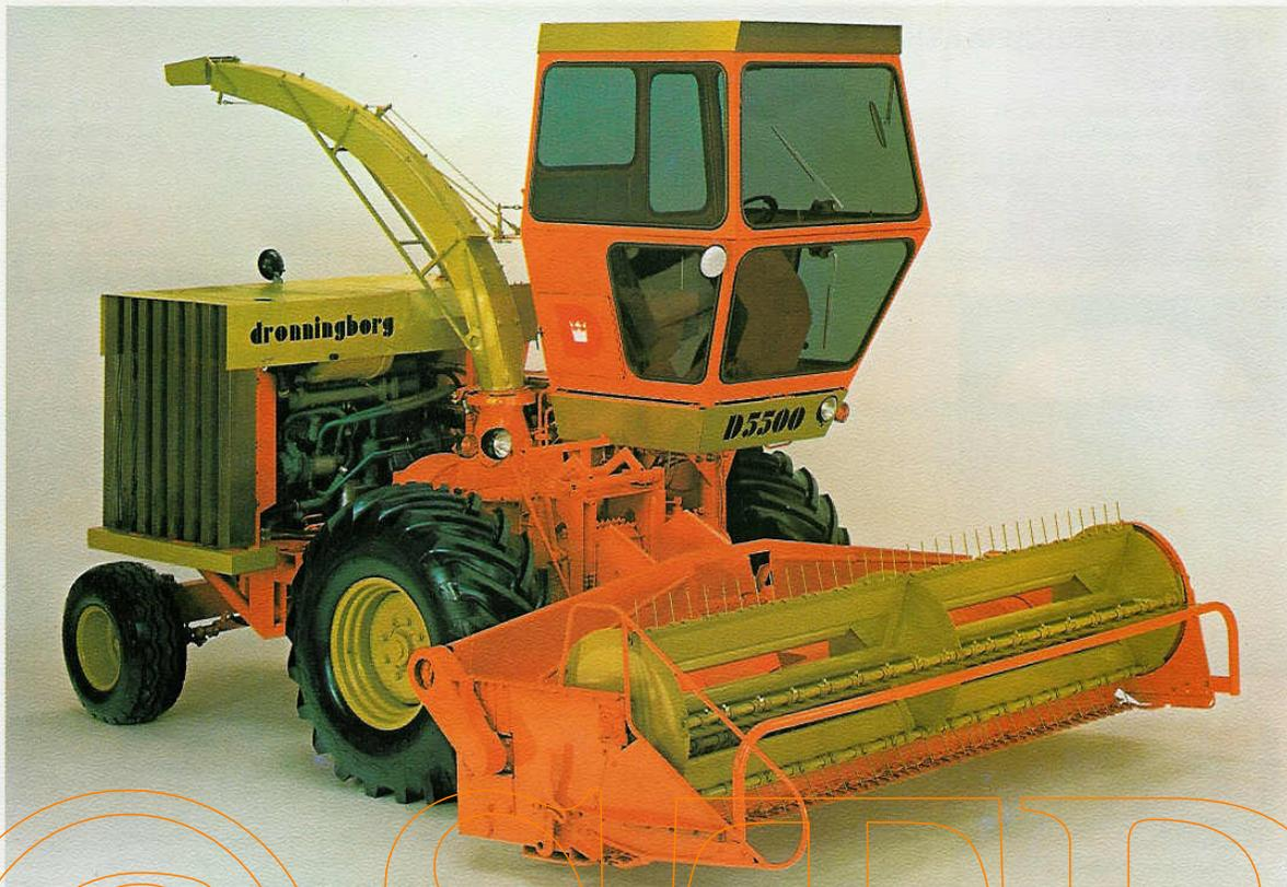
EN KRAFTIG MOTOR PÅ 240 HK, SPECIELLE HÅRDTMETALBELAGTE KNIVE, OG ET EFFEKTIVT TRANSMISSIONSSYSTEM BETYDER DRIFTSSIKKERHED UNDER ALLE FORHOLD
