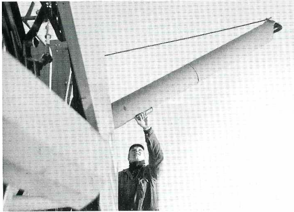
Die Höhe des Kornauslaufs am Tank ist groß genug — auch für hochbordige Anhänger oder Lastkraftwagen.
