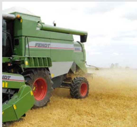
Die Mähdrescher der E- und L-Serie sind serienmäßig mit dem leistungsstarken Strohhäcksler ausgestattet.
