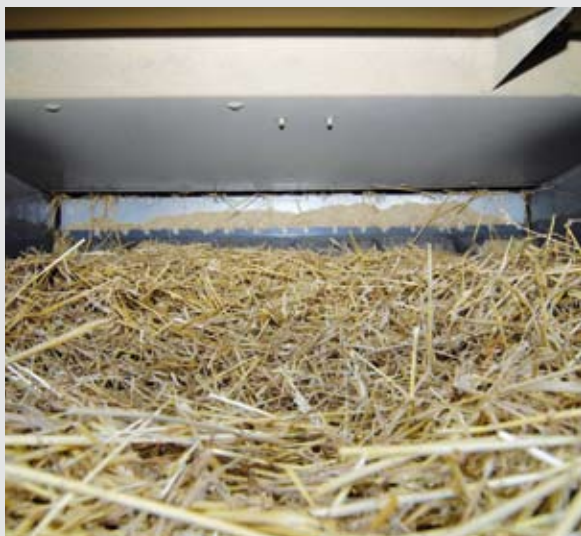
Der Blick auf die Schüttler: Eine gleichmäßige und dünne Strohmatte sorgt für effiziente Restkornabscheidung.
