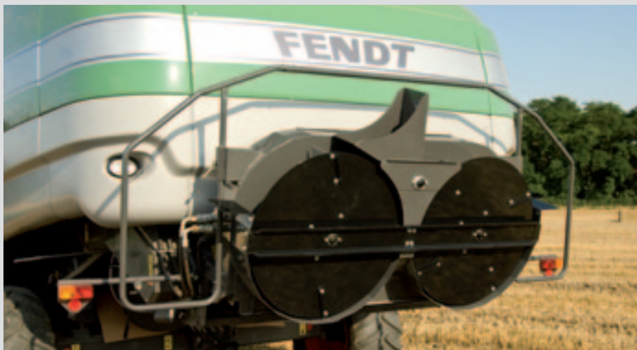
Mit dem Maxi Spread Radialverteiler ist eine noch gleichmäßigere Verteilung des gehäckselten Strohs auf die gesamte Arbeitsbreite garantiert.
