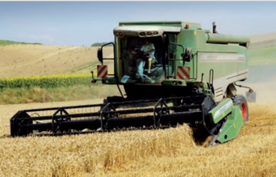
Gleichbleibender Durchsatz und geringes Verlustniveau am Hang mit dem Auto Level Mährescher.
