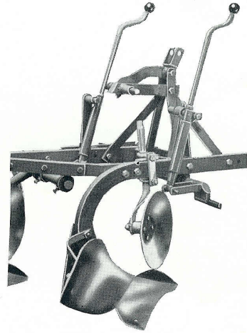
KU-RA Nav Model 20 T monteret paa roterende Forplov paa Traktorplov
