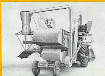
Avneblæser og cyclone er monteret. Afsæknin- gen sker paa sækkeplatformen. Anvendes hvor ovner (og hamse) ønskes opsamlet.
